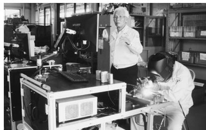
溶接技量評価装置を用いた溶接作業
