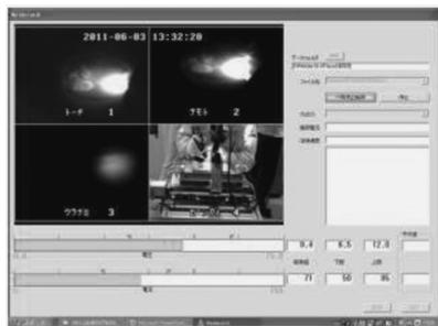
画像1 溶接技量評価装置を用いた溶接評価 映像例
